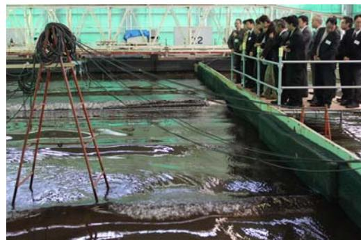
平面水槽での波浪実験の様子
