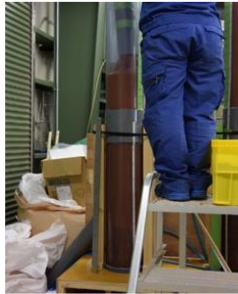
②破碎瓦の投入
