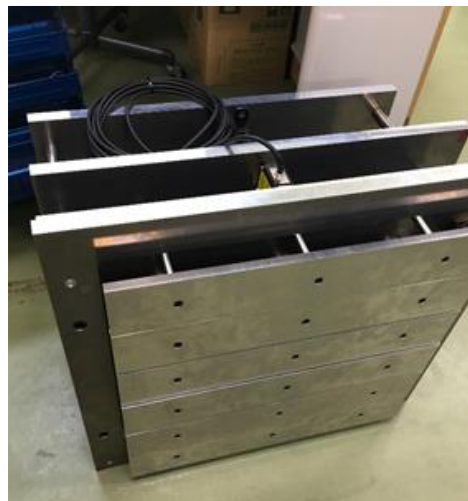
図 5.4 ロードセル設置版
