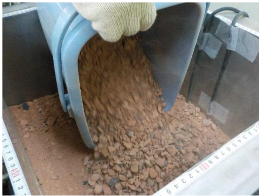
(1) 地盤材料の投入
