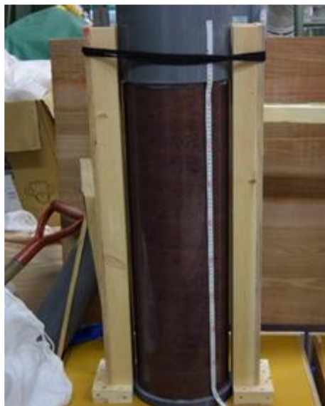
③堆積した破碎瓦
