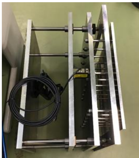
図 5.4 ロードセル設置版
