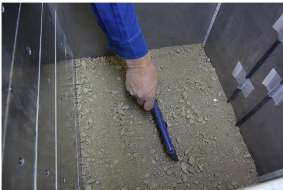
(2) 地盤材料の敷き均し
