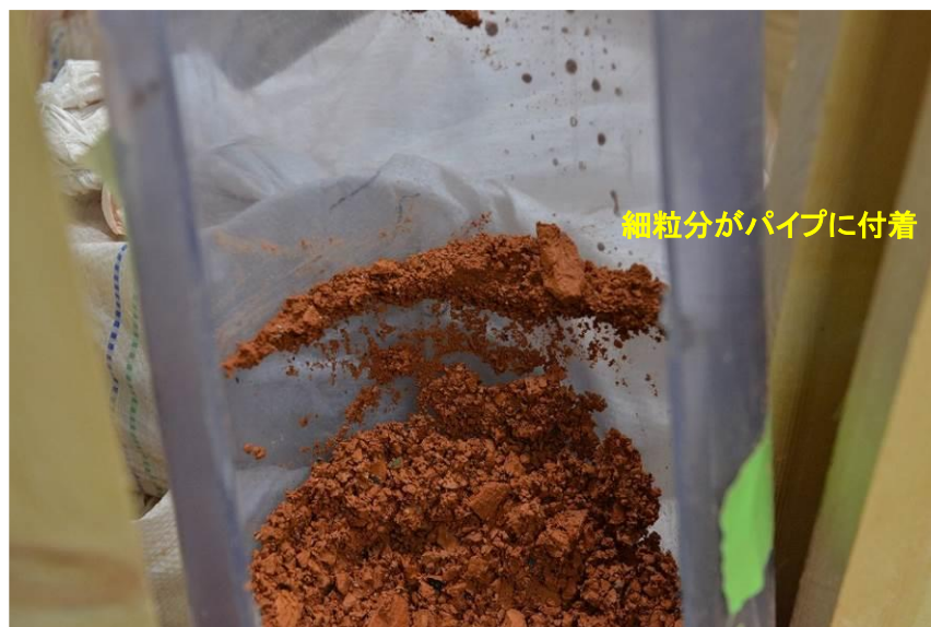
写真 2.9 パイプ周りに付着した細粒分
