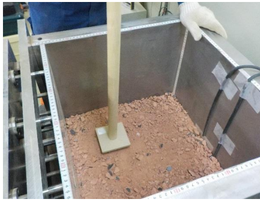
図 5.7 地盤材料の締め固め状況
