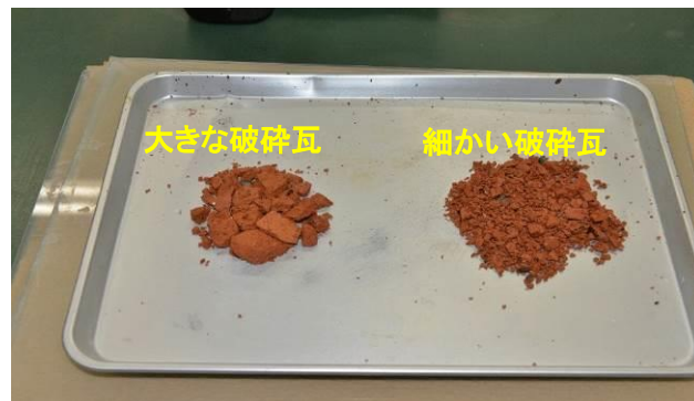
写真 2.8 分離して堆積した破砕瓦
