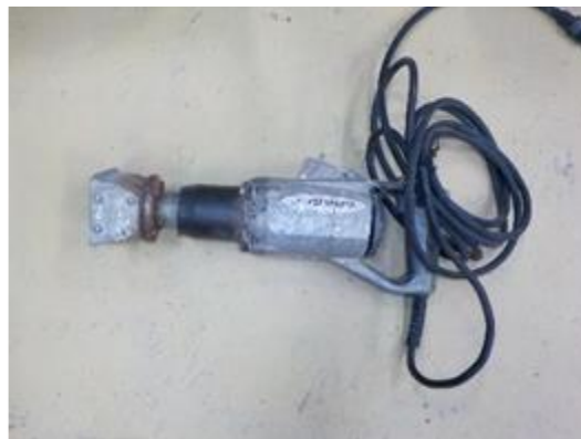
写真 2.14 外振バイブレーター
