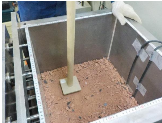
図 5.7 地盤材料の締め固め状況
