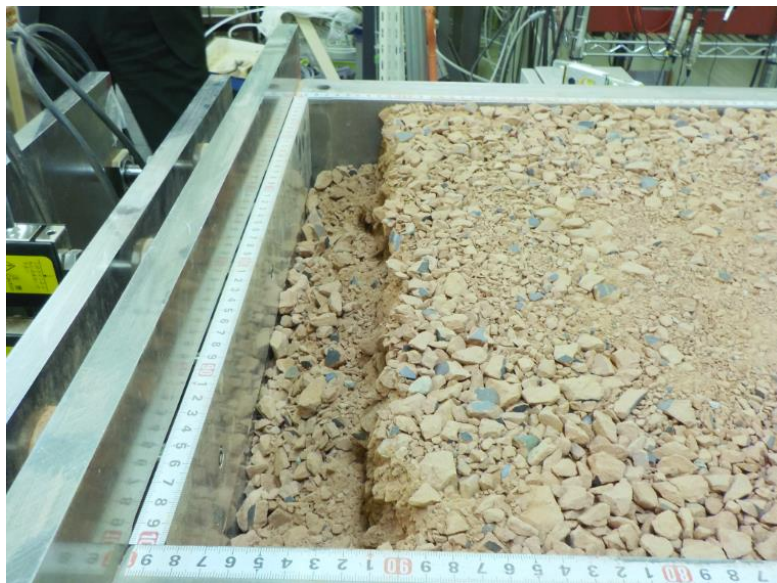
図 5.20 実験終了後の側壁移動に伴う破砕瓦の崩壊状況
