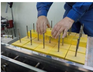
(1) 重錘の設置状況
