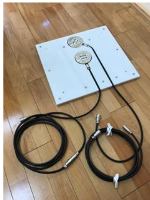
(2)土圧計設置用加工平板
