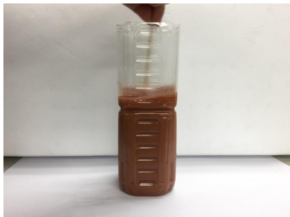
②破碎瓦(0-0.5mm)投入、1分間攪拌
