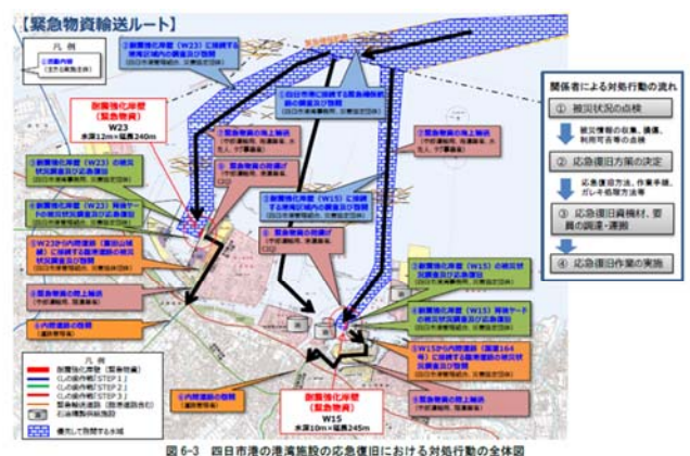
図6-3 四日市港の港湾施設の応急復旧における対応行動の全体図
